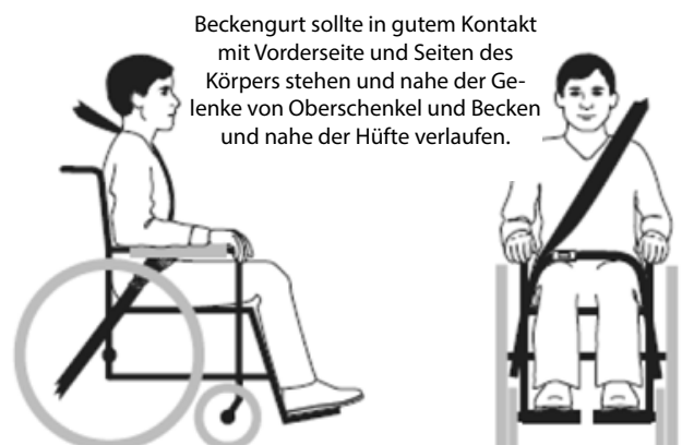
Abb. 3b – Ordnungsgemäßer Verlauf und Positionierung des Sicherheitsgurtes am Rollstuhlsassen.
