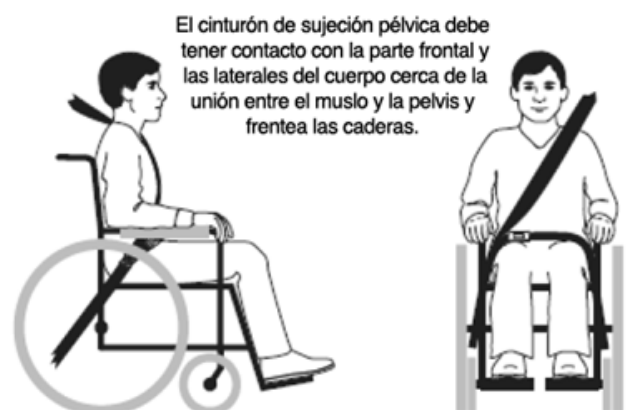
Figura 3b - Ubicación y posicionamiento correcto del cinturón de sujeción en el ocupante de la silla de ruedas
