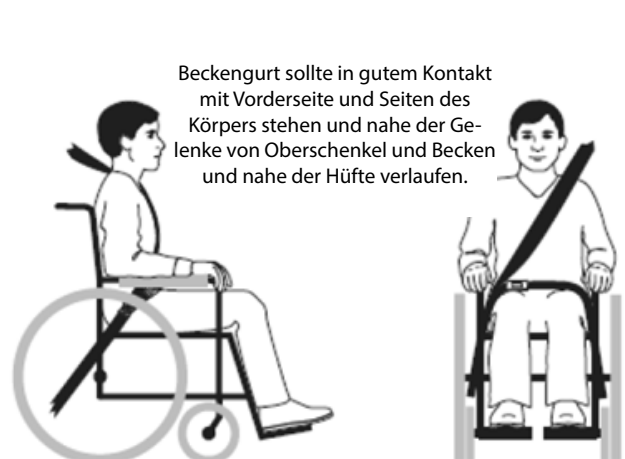
Abb. 3b – Ordnungsgemäßer Verlauf und Positionierung des Sicherheitsgurtes am Rollstuhlsassen.
