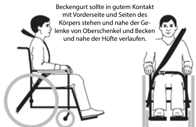
Abb. 3b – Ordnungsgemäßer Verlauf und Positionierung des Sicherheitsgurtes am Rollstuhlinassen.
