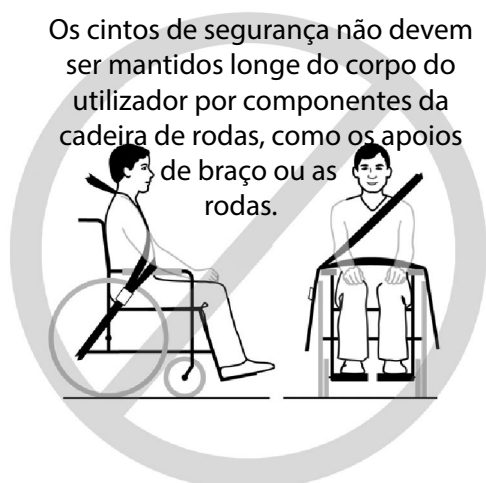
Figura 3a - Posicionamento incorreto do cinto pélvico sobre os suportes da cadeira de rodas.
