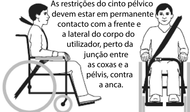
Figura 3b - Rotação e posicionamento adequados dos cintos de segurança, no utilizador da cadeira de rodas.
