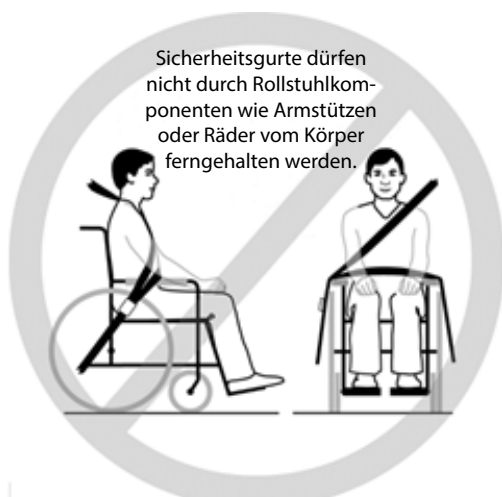
Abb. 3a – Unzulässige Positionierung des Beckensicherheitsgurtes über die Rollstuhlarmlehnen
