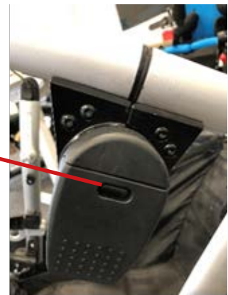
T Schraube ist nicht beschädigt
