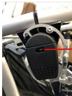
Beschädigte T Schraube ist sichtbar durch die Klappklappe
