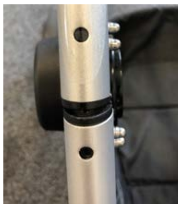
Spalt an der Klappverbindung und Verriegelungsscheibe ragt hervor
