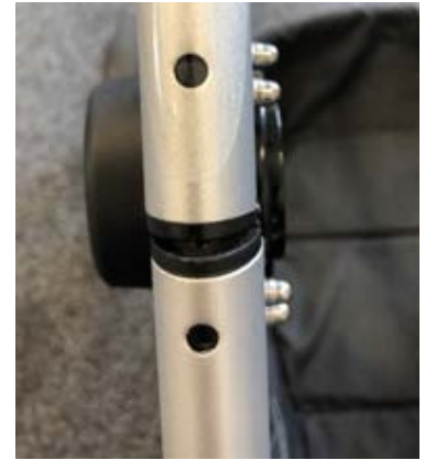
Espacio en la junta plegable y el disco de bloqueo sobresaliendo
