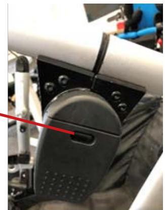
El tornillo en T no está dañado
