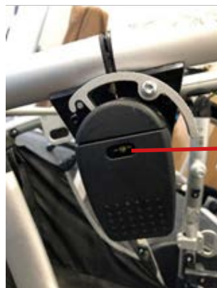
El tornillo en T dañado está visible a través de la pestaña de pliegue.
