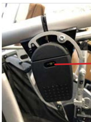
Il bullone a T danneggiato è visibile attraverso la linguetta pieghevole.
