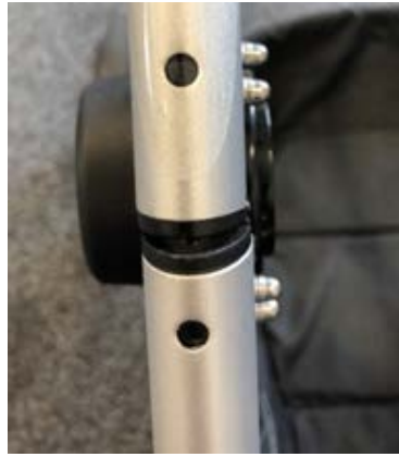
Fessura sul giunto pieghevole e sul disco di bloccaggio sporgente
