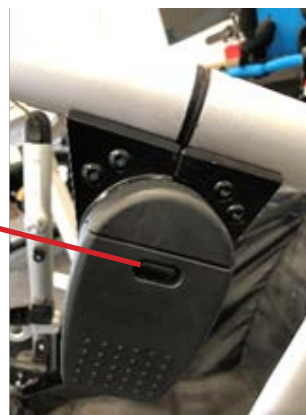
Il bullone a T non risulta danneggiato
