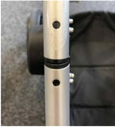
Nessuna fessura sul giunto pieghevole
