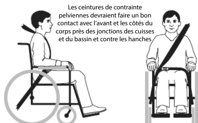
Figure 3b – Acheminement et positionnement corrects des ceintures de contrainte sur l'occupant du fauteuil roulant.
