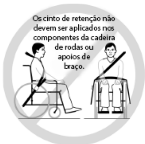
Figura 3a - Posicionamento incorreto de cinto pélvico de retenção sobre apoios da cadeira de rodas.
