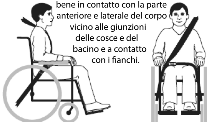
Figura 3b – Collocazione e posizionamento adeguati delle cinture di sicurezza sull'occupante della sedia a rotelle.
