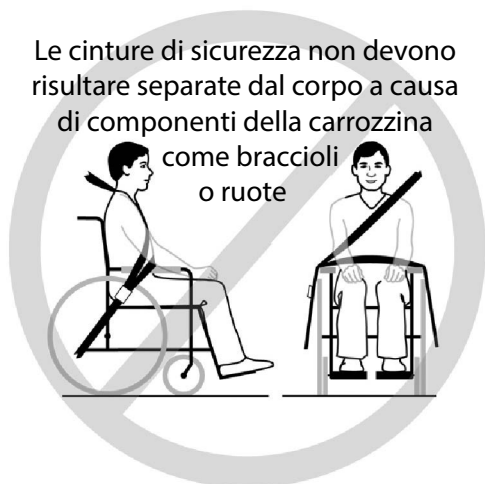
Figura 3a – Posizionamento errato della cintura di sicurezza pelvica rispetto ai supporti per sedie a rotelle.
