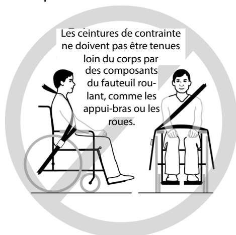
Figure 3a – Positionnement incorrect des ceintures de contrainte pelviennes sur les supports du fauteuil roulant.
