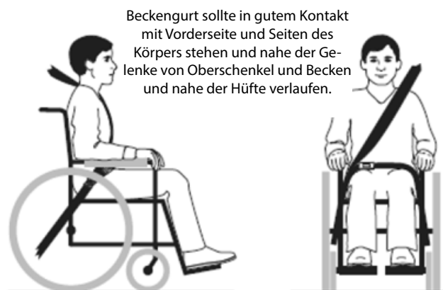
Abb. 3b – Ordnungsgemäßer Verlauf und Positionierung des Sicherheitsgurtes am Rollstuhlinassen.
