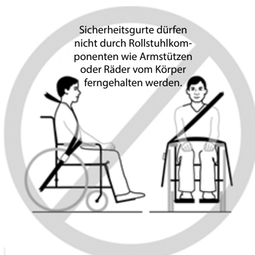
Abb. 3a – Unzulässige Positionierung des Beckengurtes über die Rollstuhlarmlehnen
