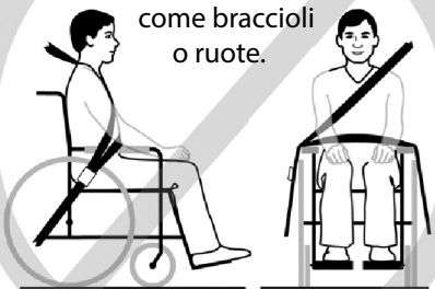
Figura 3a – Posizionamento errato della cintura di sicurezza pelvica rispetto ai supporti per sedie a rotelle.
