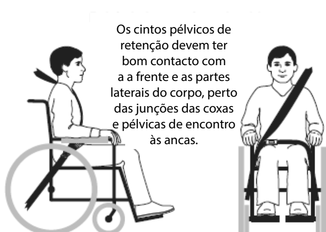
Figura 3b - Posicionamento correto de cintos de retenção do ocupante de cadeira de rodas.
