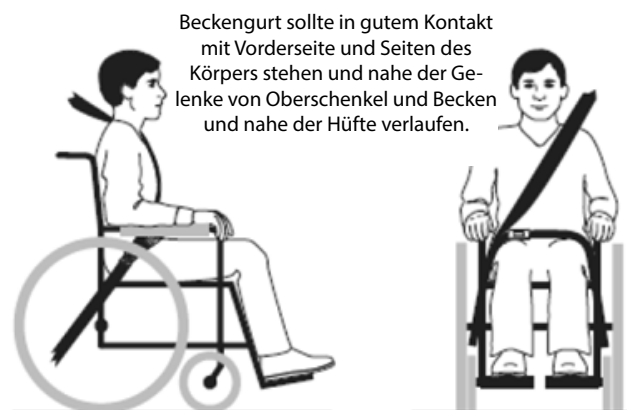
Abb. 3b – Ordnungsgemäßer Verlauf und Positionierung des Sicherheitsgurtes am Rollstuhlinnsassen.
