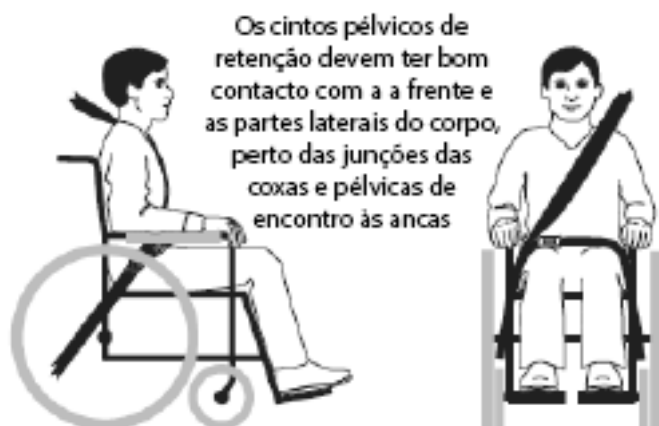
Figura 3b - Posicionamento correto de cintos de retenção do ocupante de cadeira de rodas.
